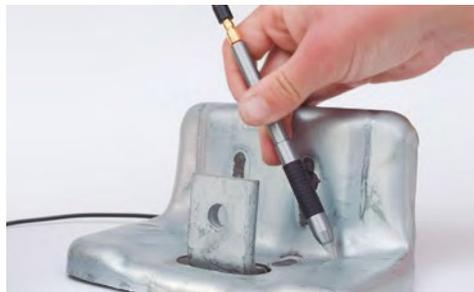
Con el transductor DKL1225PP tipo lápiz se puede medir espesores en radios pequeños, en espacios reducidos.
