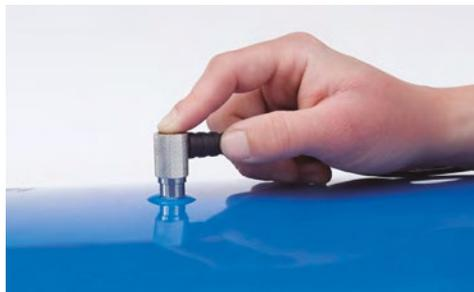
El uso del transductor DKL337EE permite al equipo medir discriminando el recubrimiento y además medir su espesor.
