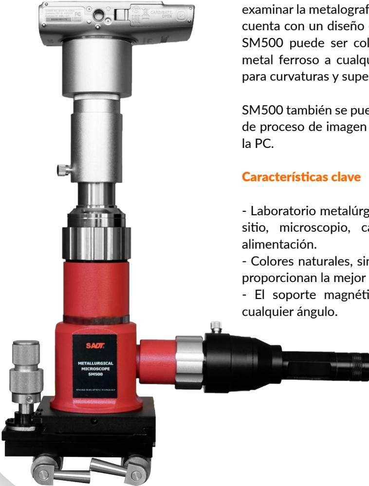
El **SM500** es un **microscopio metalúrgico** portátil utilizado para examinar la metalografía de metales en laboratorio o en sitio, SM500 cuenta con un diseño ergonómico y un soporte magnético único. El SM500 puede ser colocado directamente contra la superficie del metal ferroso a cualquier ángulos para exámenes no destructivos, para curvaturas y superficies complicadas.
