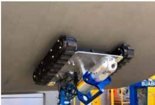
Inspección de paredes curvas de acero
