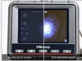
Panel de laminación completa capaz de ser operado bajo la luz del sol
